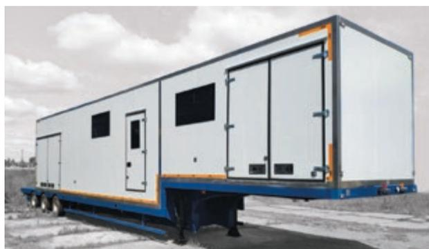
Мобильный комплекс освидетельствования баллонов на шасси полуприцепа НЕФАЗ
