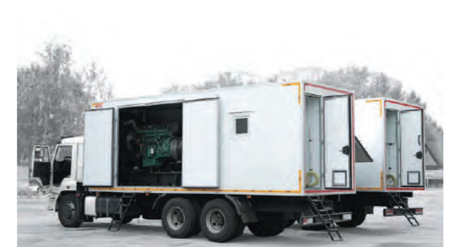
Передвижная дизельная электростанция на шасси КАМАЗ 65115
