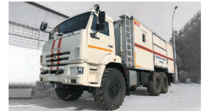
Аварийно-спасательная машина на шасси КАМАЗ 43118
