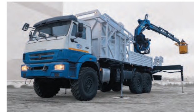
Опоровоз с КМУ ИНМАН ИМ 240 на шасси КАМАЗ 43118
