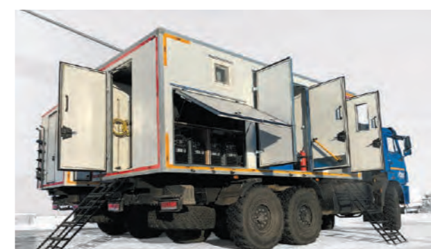
Агрегат ремонтно-сварочный на шасси КАМАЗ 43118
